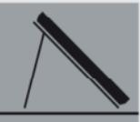
**Montage Stockschraubenbefestigungssystem, 45 ° angehoben**
