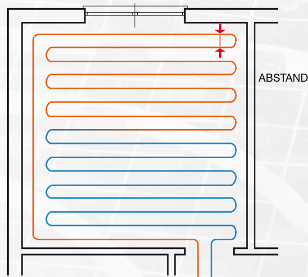
Serpentinenförmige Verlegung mit konstantem Abstand
