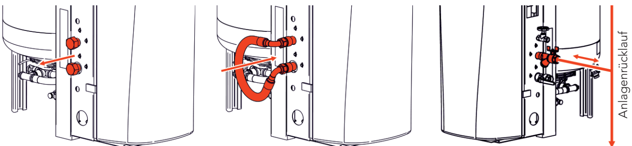
Abbildung 6: Verbindung der Anschlüsse mit dem Bypass-Set und Anschluss an den Anlagenrücklauf
