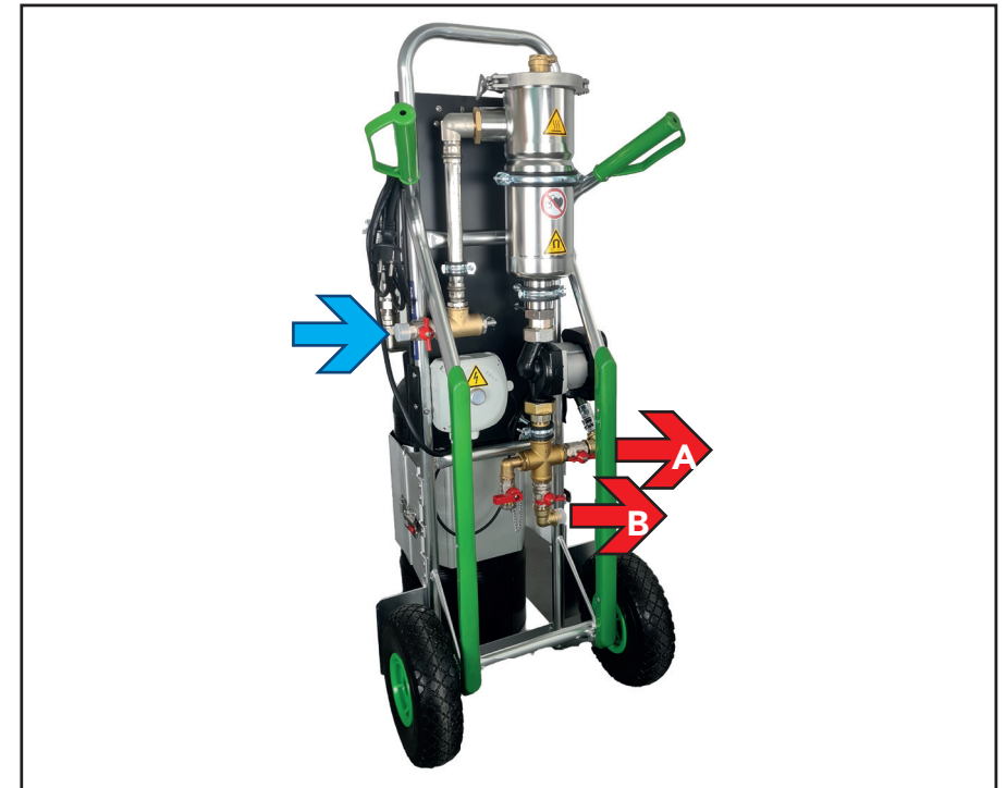
Fig. 5-5: Diagram over filtreringstilslutning
