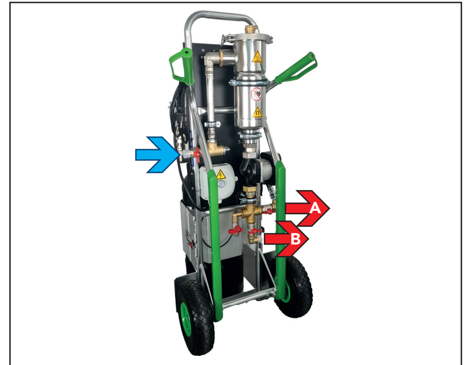
Figuur 5-5: Aansluitschema filtratie
